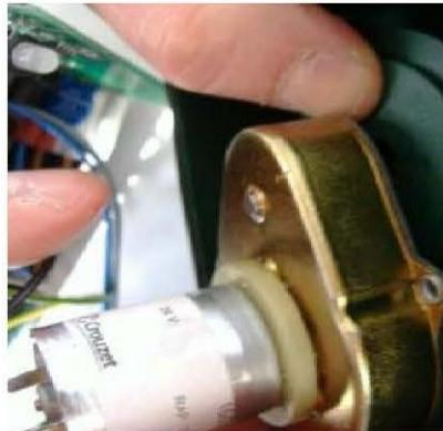
С помощью отвертки слега приподнять двигатель насоса-дозатора.
