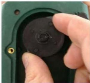
3. Повернуть ролики с блоком фиксатором как показано на рисунке.
